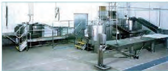
■ Head & Feet dehairing line with optional hoof remover & head splitter 头蹄脱毛线, 可选去蹄壳机 & 头劈半机
