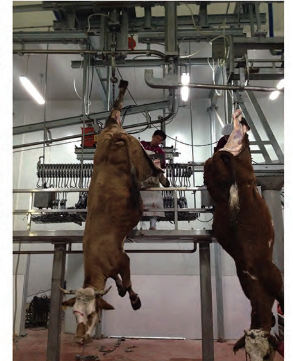
NO.2 ▼ Pneumatic swing arm, capacity 60 ph 气动摆臂, 产量60头每小时
