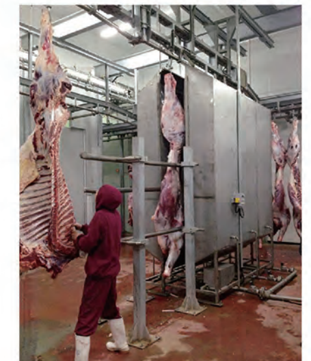
Fully automatic High pressure spray system on upper, middle & bottom 全自动高压冲淋系统, 上中下三段
